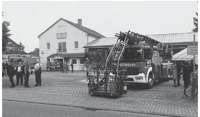
Im Vordergrund eine Drehleiter mit einem abknickbaren Rettungskorb.
